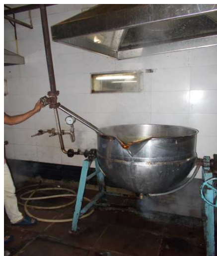
写真3 二重底構造をした調理用蒸気鍋
